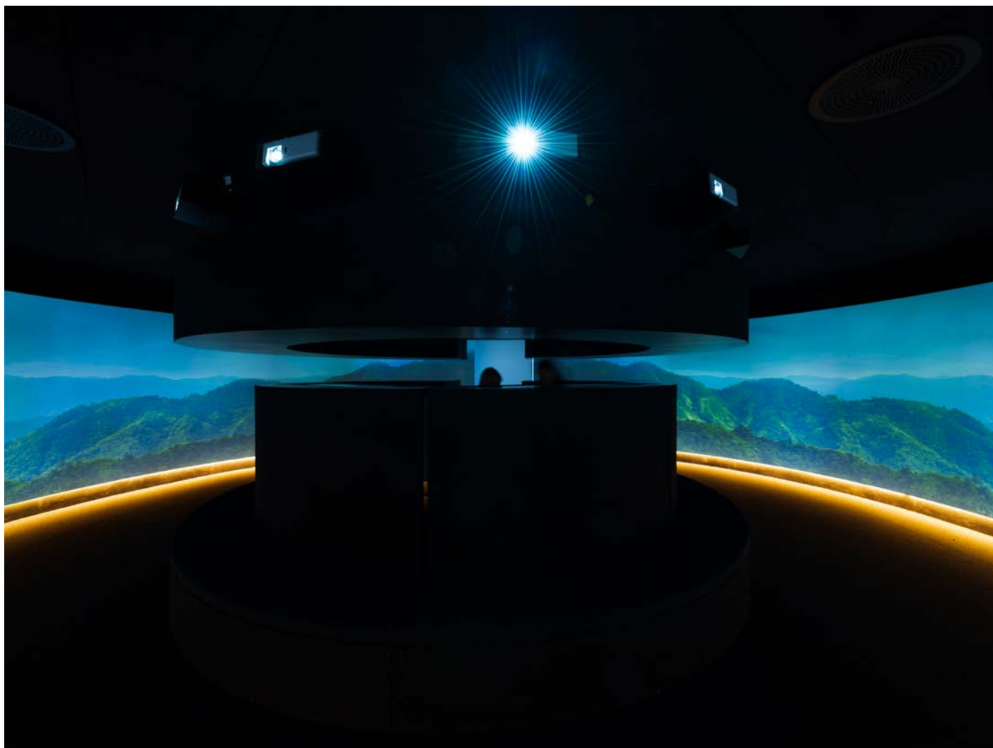
12 Sammanflätade projektörer skapar en stor omslutande projektionsyta, på sammanlagt över 24 miljoner pixlar.
