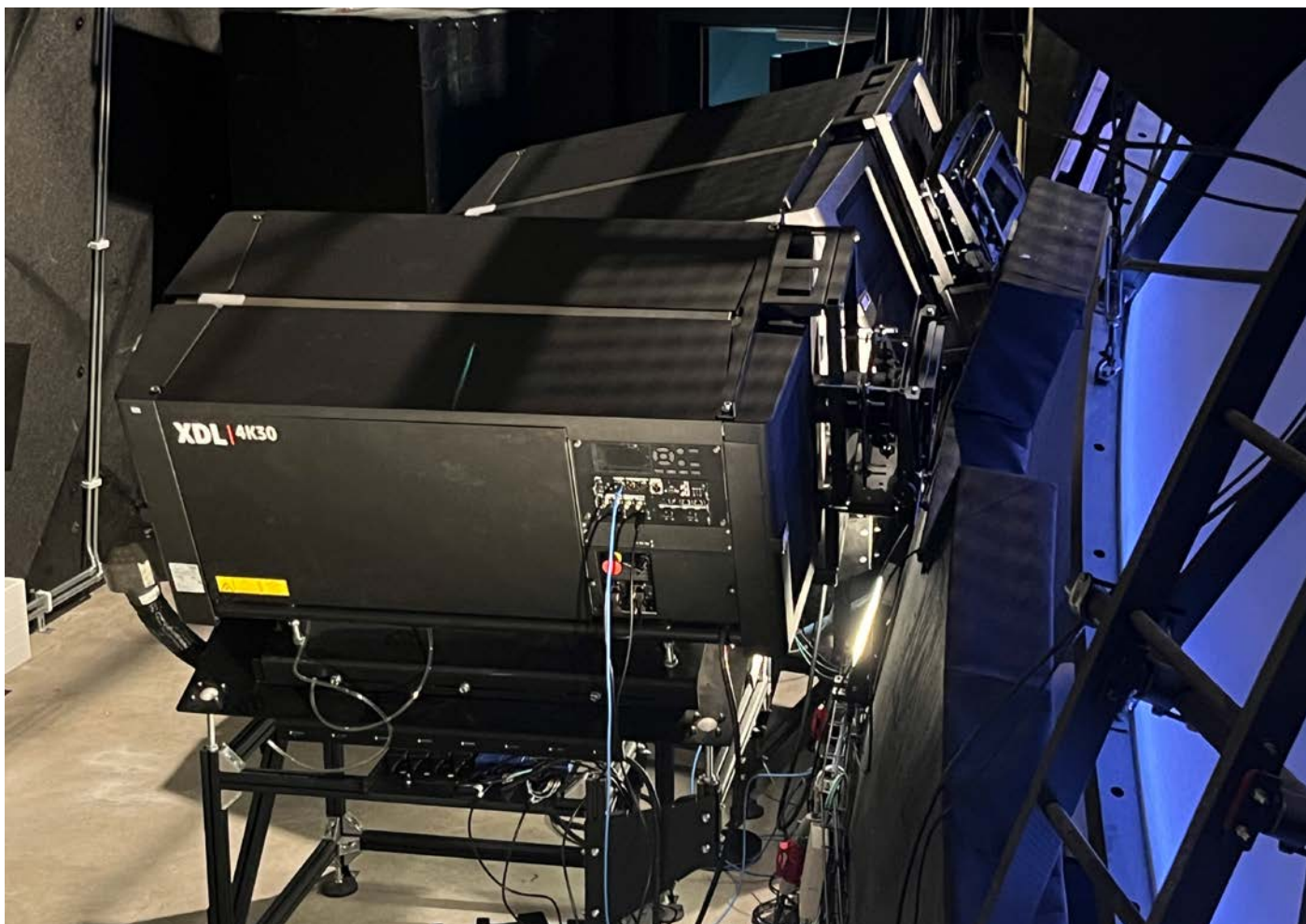
Domen är utrustad med sex vätskekylda XDL 4K30 projektorer från Barco, som tillsammans täcker upp skärmens yta på 442 kvadratmeter
